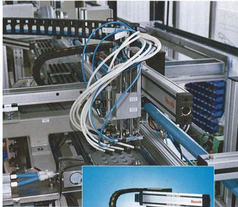
Bewährte Großserientechnik: Das CMS basiert auf den Compact Modulen CCK von Rexroth und darauf abgestimmten Motor-/Reglerkombinationen
